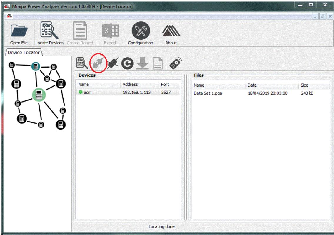
Para efetuar o controle remoto através do software deverá clicar em “Remote Control” conforme evidencia em vermelho abaixo, com isso irá abrir uma interface do analisador para controle pelo computador:
