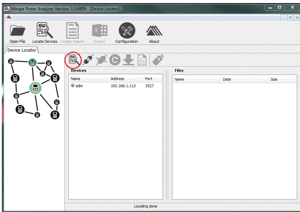
Para Efetuar a conexão do analisador com o software para visualização de dados é necessário clicar em “Conect to Select Device”, conforme evidenciado abaixo para obtenção de registros:
