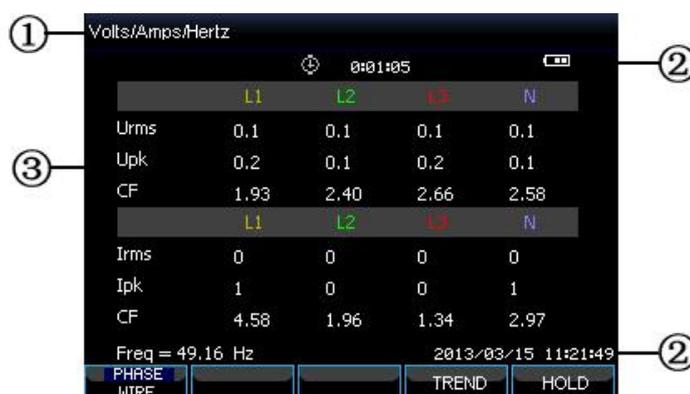
Essa tela fornece uma visão geral dos valores de medição de tensão, corrente e frequência.
